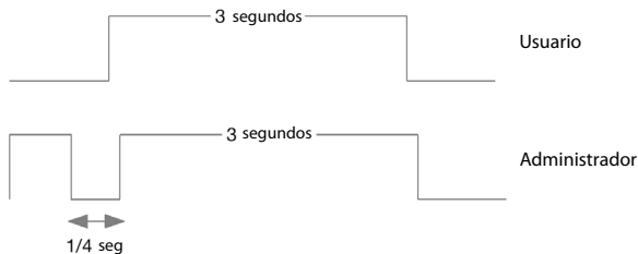
(Imagen de muestra) Entrada de la llave para la selección de modo Usuario/Administrador
